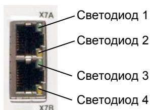
Состояние обмена данными сигнализируется с помощью встроенных светодиодов.
