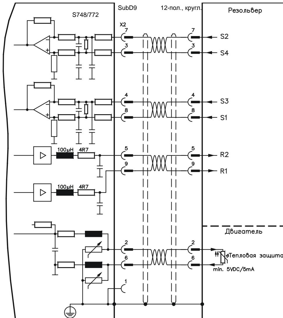
Расположение выводов со стороны датчика относится к двигателям Kollmogen.
