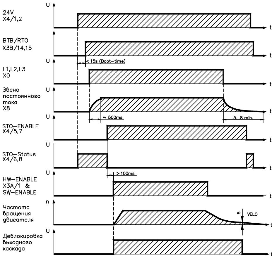
Приборы с разблокированной функцией «Стояночный тормоз» обладают специальным циклом для отключения выходного каскада ( $\Rightarrow$  стр. 31).
