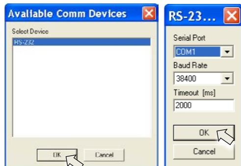
При первоначальном создании соединения вас попросят настроить параметры связи. Выберите коммуникационную систему и интерфейс, с которым соединен сервоусилитель и щелкните OK.
