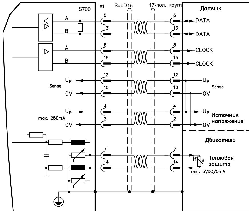
Расположение выводов со стороны датчика относится к двигателям Kollmogen.
