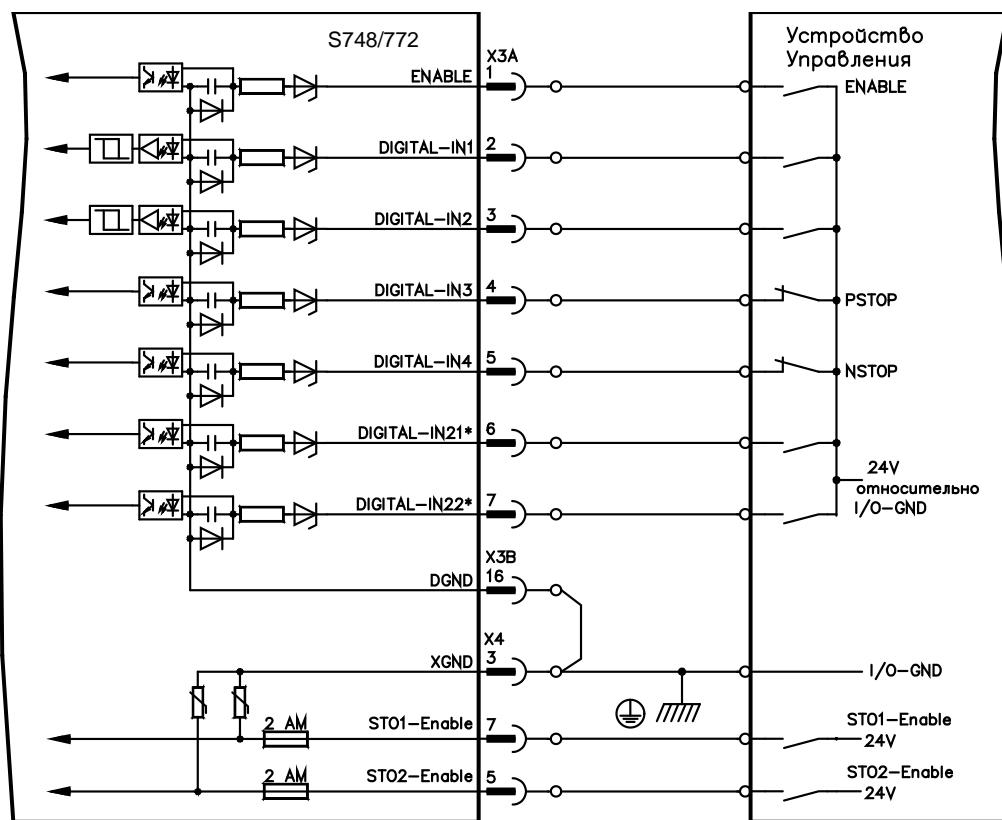
\* DIGITAL-IN 21/22 необходимо определить с помощью программного обеспечения для ввода в эксплуатацию в качестве входов (экранная страница «Digital I/O» (Цифровые входы/выходы))
