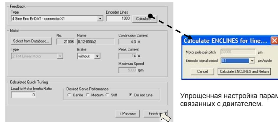
Упрощенная настройка параметров, связанных с двигателем.
