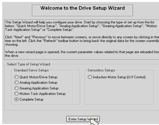
Для быстрого тестирования функций выберите тип установки «Quick Motor/Drive Setup» (Быстрая настройка)
