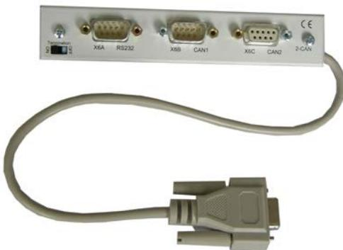
Штекерный разъем X6 сервоусилителя SERVOSTAR предназначен для сигналов интерфейса RS232 и интерфейса CAN. Поэтому расположение выводов интерфейсов не является стандартным и, если вы собираетесь использовать оба интерфейса одновременно, для них требуется специальный кабель. Модуль расширения шины 2CAN представляет интерфейсы с раздельным исполнением разъемов SubD. Оба разъема CAN (CAN-IN и CAN-OUT) подключаются параллельно.
