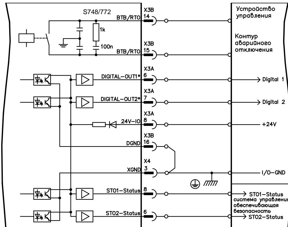
\* DIGITAL-OUT1/2 необходимо определить с помощью программного обеспечения для ввода в эксплуатацию в качестве выходов.
