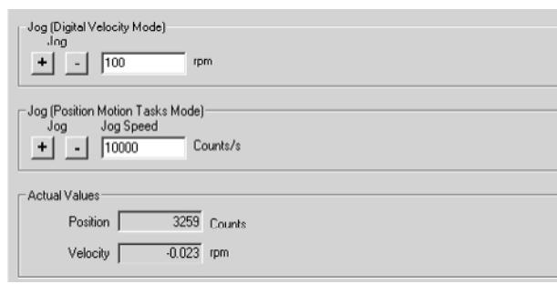
**Jog (Digital Velocity Mode):** (Старт-стопный режим (цифровое регулирование частоты вращения))
